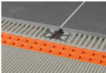
Schlüter-DILEX-FCS è un profilo con lati in PVC rigido rigenerato che funge da alloggiamento per l'inserto Schlüter-DILEX-FIS, per creare un giunto di dilatazione particolarmente sottile, senza protezione dei bordi e senza stuccatura cementizia fra giunto e rivestimento. DILEX-FCS viene fornito con una copertura protettiva integrata da rimuovere dopo la posa delle piastrelle per accogliere l'inserto DILEX-FIS.
