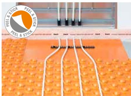
Il pannello di livellamento Schlüter-BEKOTEC-ENFGK-PS viene utilizzato nelle zone di passaggio porta e vicino ai collettori, per facilitare i collegamenti e per ridurre al minimo gli scarti. Il pannello è autoadesivo sul retro ed è provvisto di una pellicola protettiva.
