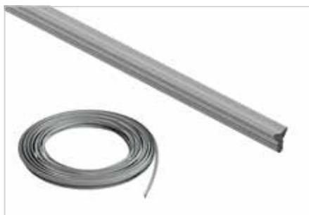
Schlüter-DILEX-FIS è un inserto in materiale siliconico catalizzato al platino, fornito in rotolo, con larghezza di circa 3,5 mm. È disponibile nei colori comunemente utilizzati per le fughe, elencati di seguito. L'inserto viene inserito in leggera compressione, in modo rapido e uniforme nel profilo Schlüter-DILEX-FCS precedentemente installato, utilizzando l'ausilio di installazione in dotazione. Variazioni involontarie di lunghezza sono impediti dalla protezione integrata.
