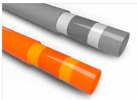
Schlüter-BEKOTEC-THERM-HR è un tubo per riscaldamento composto da 5 strati in pregiato materiale polimerico (PE-RT) con all'interno barriera all'ossigeno. Il tubo da riscaldamento ad elevata flessibilità e conforme alla normativa DIN 16833 è stato specificamente concepito per l'uso con i pannelli del sistema BEKOTEC. E' impermeabile all'ossigeno secondo norma DIN 4726. La sua qualità certificata è soggetta ad un continuo monitoraggio.
