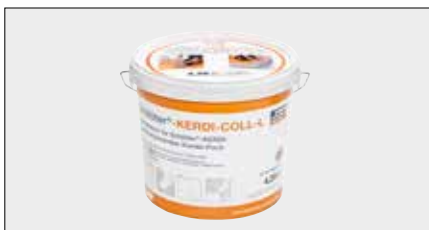
Schlüter®-KERDI-COLL-L Collante impermeabilizzante bicomponente, composto da una base acrilica liquida priva di additivi e da una polvere reagente a base cementizia. Questo collante è adatto per essere utilizzato nelle zone di giunzione dei teli della guaina Schlüter-KERDI, quando si crea il sormonto o si utilizza la fascetta sigillante.
